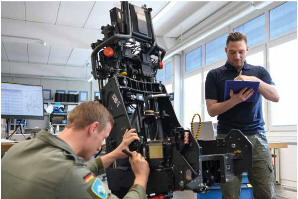
Dokumentation technischer Arbeiten am Schleudersitz
