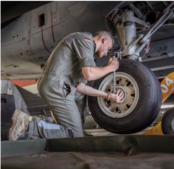
Reifenwechsel an einem TORNADO
