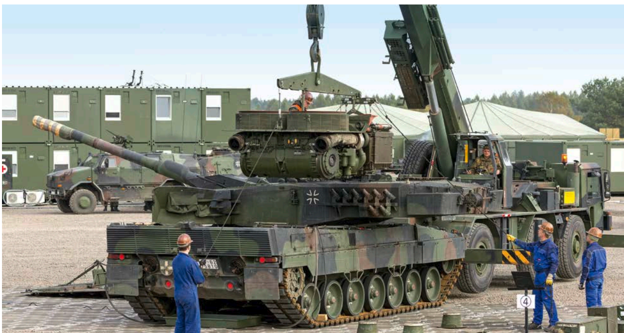
Spezialisten tauschen das Triebwerk bei einem Leopard 2A6
