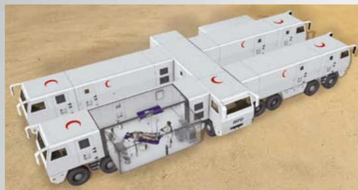
Gekoppelte Zivilfahrzeuge mit ausfahrbarer OP-Einheit.
